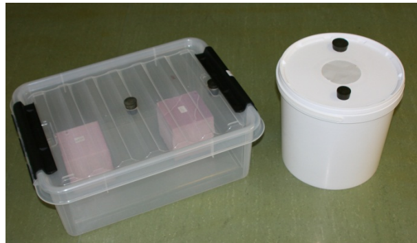
Bilde 3: Kasser brukt til å teste isolasjonens evne til å motstå reirutgraving forårsaket av stökkmaur ( Camponotus ligniperda ).
